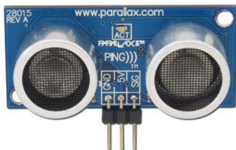
ภาพที่ 5-1 เซ็นเซอร์ตรวจจับคลื่นเสียงความถี่สูง
