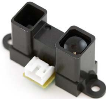
ภาพที่ 2-5 เซ็นเซอร์อินฟราเรด
