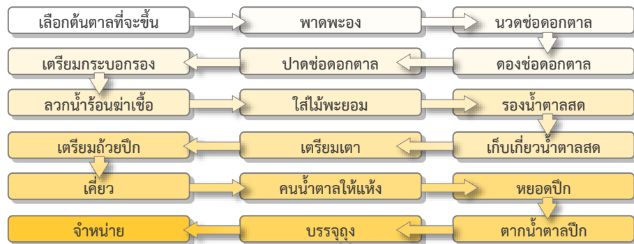
ภาพที่ 1 สรุปขั้นตอนการผลิตน้ำตาลโดนด
