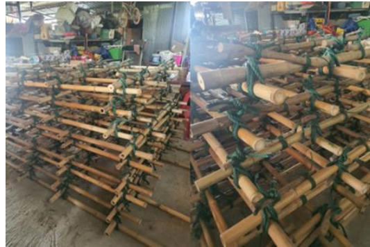
ภาพที่ 3: ลักษณะของการจัดเรียงไม้ไผ่เพื่อที่จะทำการประกอบเป็นรูปทรง 3 มิติ แหล่งที่มา: ญัฐพิสิษฐ์ พลับขจร (ถ่ายเมื่อวันที่ 15/8/2566)
