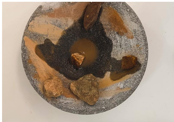
ภาพที่ 3 การทดสอบสีโดยการนำดินจุ่มน้ำและถูกับครกหินเพื่อให้เกิดสี
