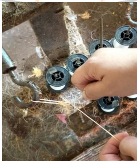
ภาพที่ 6 การผูกเส้นไหมกับห่วงเชือกในลอน
