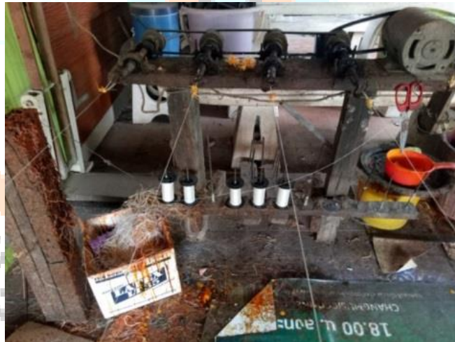
ภาพที่ 9 การเดินไหมทั้ง 4 ตะขอ ที่มา: สุภาสิริร์ ปิยะพิพัฒน์, 2561
