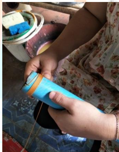
ภาพที่ 15 การม้วนเส้นไหมใส่กระบอกท่อ PVC ที่มา: สุภาสิริร์ ปิยะพิพัฒน์, 2561
