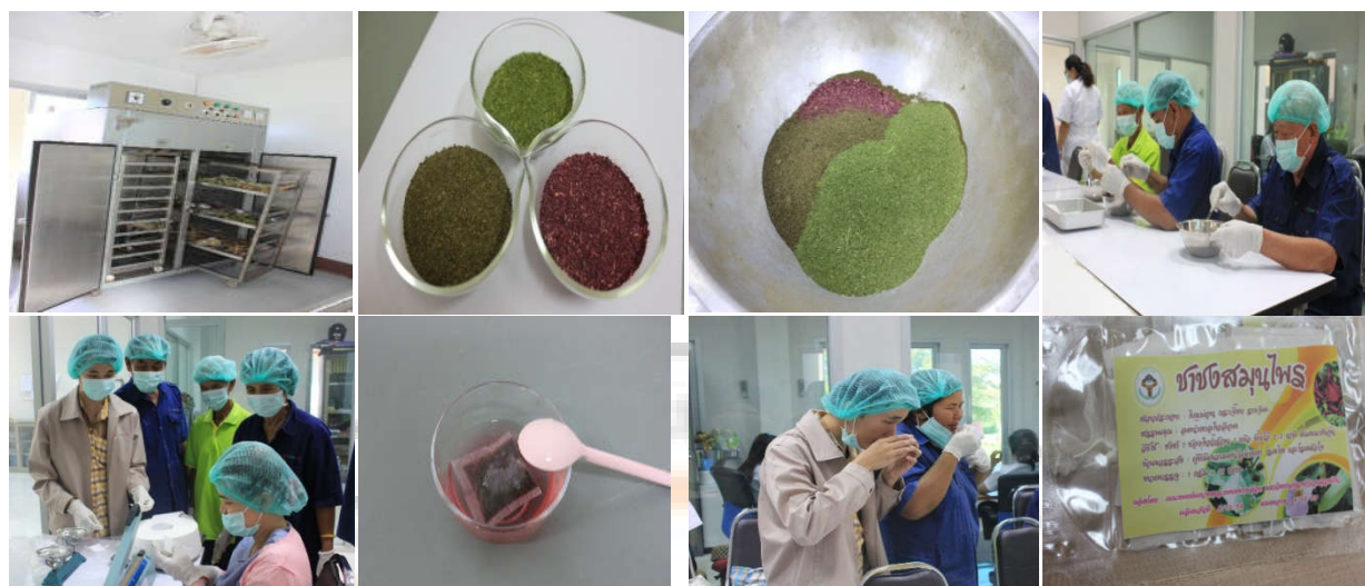
ภาพที่ 5 วิธีการแปรรูปและผลิตขมิ้นสมุนไพรเรียงจากซ้ายไปขวาและบนลงล่าง คือ การอบสมุนไพร ผงยาที่บดแล้ว การผสมผงยา การบรรจุผงยาลงในซองชา การปิดปากถุง ทดสอบการละลาย ทดสอบรสชาติ และการบรรจุในบรรจุภัณฑ์
