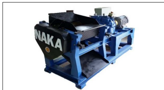
รูปที่ 5 เครื่องรียางเครป
