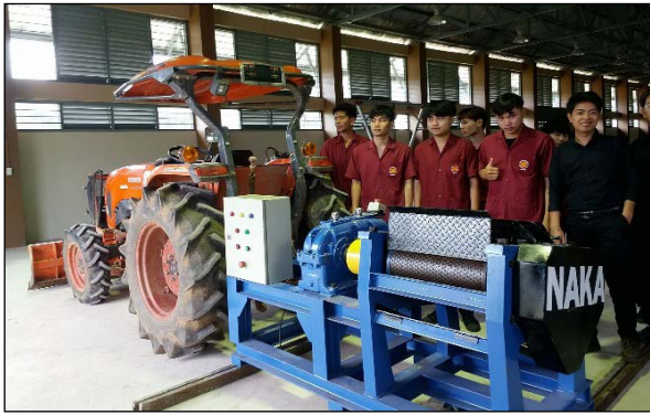
รูปที่ 7 เครื่องรีดยางเครป แบบใช้ต้นกำลังจากเครื่องยนต์รถไถคูโบตา
