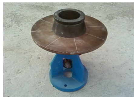
รูปที่ 3 ชุดโต๊ะทดสอบการไหลแม่
