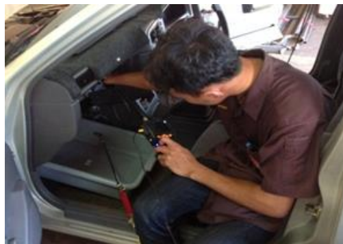
รูปที่ 8 การตรวจสอบชุดคอยล์เย็นด้วยกล้อง Snake Scope ก่อนทำการล้าง
