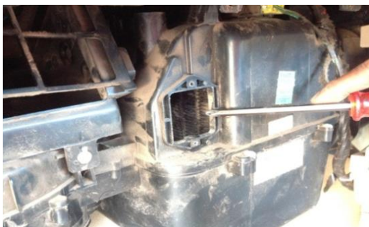
รูปที่ 7 ถอดเทอร์โมสแตต์ออกก่อนทำการตรวจสอบและล้างทำความสะอาดชุดคอยล์เย็น
