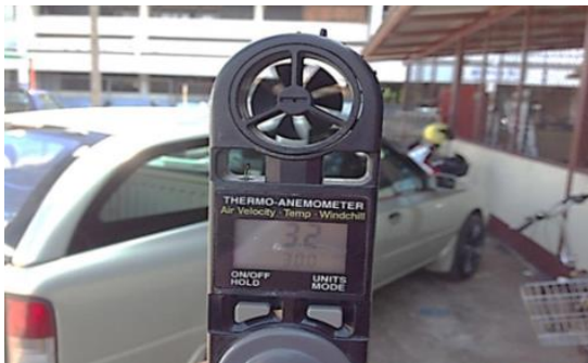
รูปที่ 3 วัดอุณหภูมิและความเร็วลมภายนอกห้อง โดยสารรถยนต์
