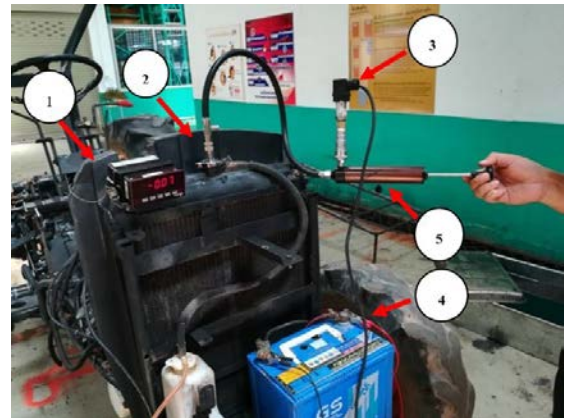
รูปที่ 3 แสดงตำแหน่งติดตั้งชุดตรวจเช็คและทดสอบเครื่องยนต์คูโบต้าแบบอิเล็กทรอนิกส์ เครื่องมือวัดแรงดันน้ำมันหล่อลื่น
