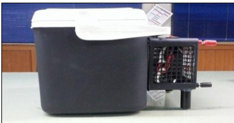
รูปที่ 5 รูปตำแหน่งการติดตั้งพัดลมระบายความร้อน
