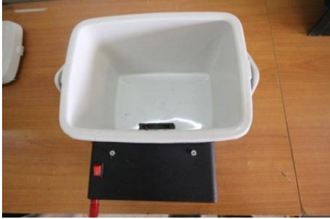
รูปที่ 4 การติดตั้งแผ่นทำความเย็น Peltier
