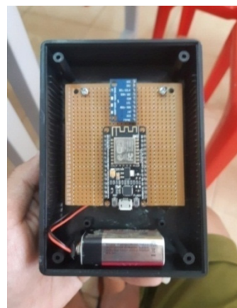
รูปที่ 5 ประกอบชุดวงจรในกล่อง
