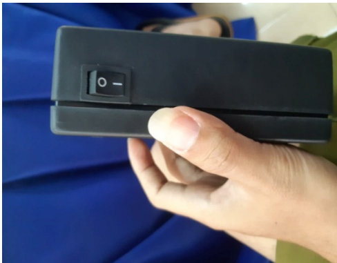
รูปที่ 6 ติดตั้งสวิทช์สำหรับกดปิดเปิดวงจรการทำงาน
