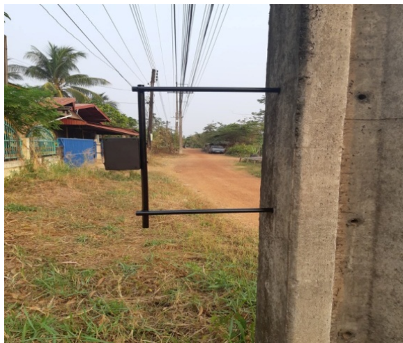
รูปที่ 7 ประกอบส่วนที่ 2 ขาโลหะสำหรับยึดเกาะตัวเครื่องกับชิ้นงาน
