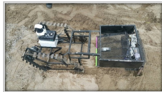
รูปที่ 6 การทดสอบสมรรถนะการเคลื่อนที่บนทราย เพื่อให้หุ่นยนต์สามารถปฏิบัติงานในสนามได้
