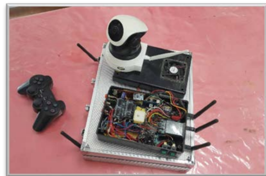
รูปที่ 2 ชุดควบคุมหุ่นยนต์ ด้วยไมโครคอนโทรลเลอร์ arduino รุ่น Nano
