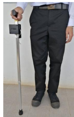
รูปที่ 7 แสดงภาพต้นแบบไม้เท้าของผู้สูงอายุแฉ่งเตือนผ่านทางไลน์แอปพลิเคชันที่ใช้ในการวิจัย
