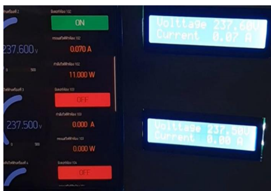
รูปที่ 14 การทดสอบการทำงานของแอปพลิเคชัน Blynk เทียบกับการทำงานของมิเตอร์ และจอ LCD 16X2
