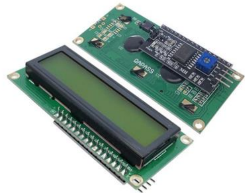
รูปที่ 8 จอแสดงผล LCD 16X2
