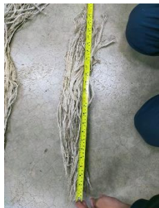
รูปที่ 11 ผ่านการลอกผิวใบสับปะรดใช้ใบมีดแบบ 12 ใบ
