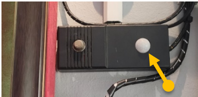
รูปที่ 9 การทดสอบการทำงานของอุปกรณ์ตรวจจับการเคลื่อนไหว
