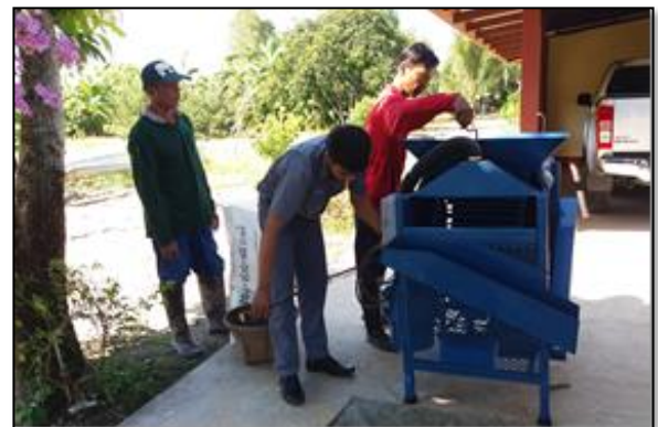
รูปที่ 3 นำเครื่องฟัดข้าวเปลือกขนาดเล็กสำหรับชุมชนไปสาธิตการทำงานให้ผู้เชี่ยวชาญทดสอบการใช้งานและประเมินคุณภาพ
