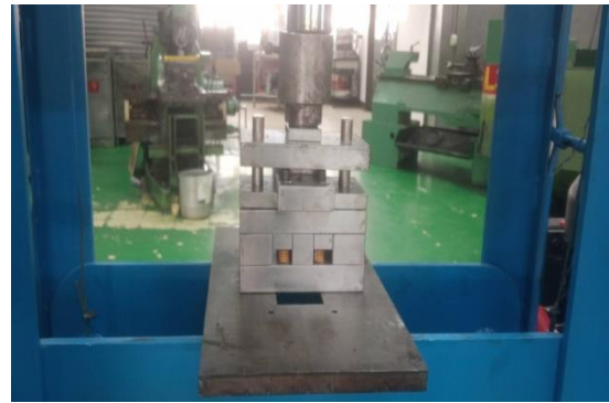
รูปที่ 4 แม่พิมพ์อัดขึ้นรูปโลหะแผ่นที่สร้างสำหรับการทดลองติดตั้งบนเครื่องกดไฮดรอลิกส์เพื่อยืนยันผล
