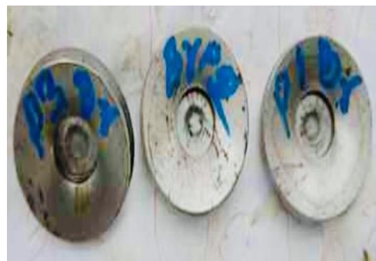
รูปที่ 1 การยุบตัวขึ้นงานทดสอบแรงเสียดทานด้วยแม่พิมพ์อัดขึ้นรูปโลหะแผ่นที่ใช้พื้นซ์เลื่อน
