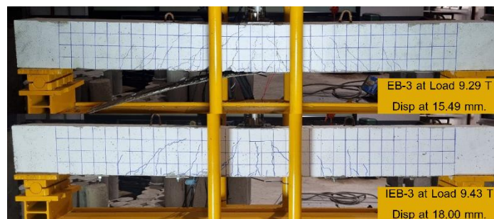
รูปที่ 7 การเปรียบเทียบกำลังน้ำหนักบรรทุกของคานทดสอบ EB-3 และ IEB-3
