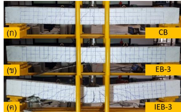
รูปที่ 5 ลักษณะการวิบัติของคานทดสอบทั้งหมด
