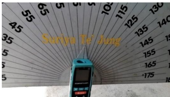
รูปที่ 1 เครื่องมือวัดมิติอุโมงค์รุ่นที่ 1 โดยนายสุริยา พิทักษ์กุล วิศวกรงานเทคนิคบำรุงทาง กองบำรุงทางขอนแก่น [1]
