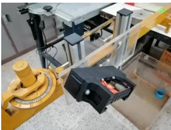
รูปที่ 9 เครื่องวัดมิติตามขวางอุโมงค์รถไฟรุ่นที่ 2 ซึ่งนำจากรุ่นที่ 1 ออกและสามารถวัดมุมได้ด้วยตนเอง [7]
