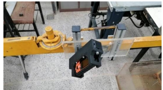
รูปที่ 3 เครื่องมือวัดมิติอุโมงค์ รุ่นที่ 2 เมื่อนำมาติดตั้งยึดกับเครื่องวัดขนาดทางแบบทันสมัยของการรถไฟฯ [2]
