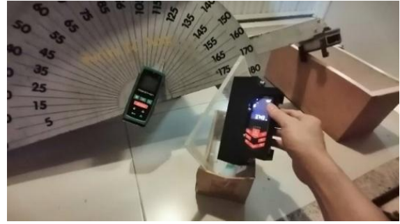
รูปที่ 2 เครื่องมือวัดมิติอุโมงค์ รุ่นที่ 2 โดย กิติเดช สันติชัยอนันต์ [2] เทียบกับเครื่องมือวัดมิติอุโมงค์ รุ่นที่ 1
