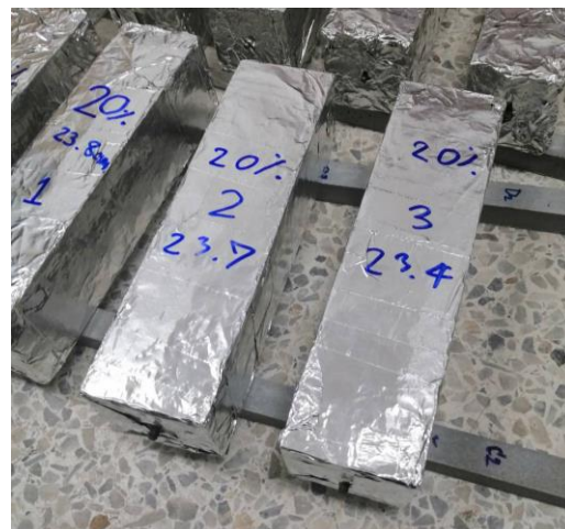
รูปที่ 5 ตัวอย่างทดสอบการหดตัวแบบออโตจีนัส
