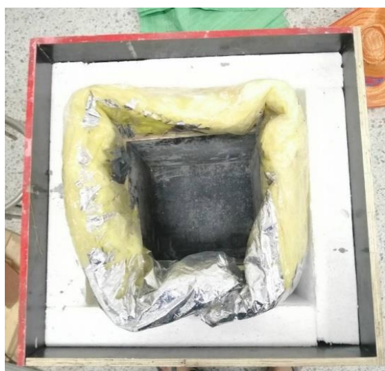
รูปที่ 3 แบบหล่อคอนกรีตสำหรับทดสอบความร้อน
