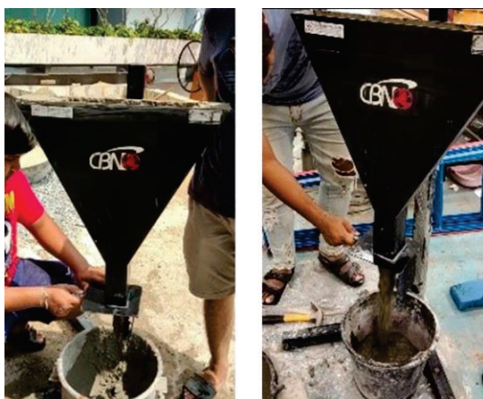
รูปที่ 3 การทดสอบระยะเวลาไหลผ่าน V-funnel
