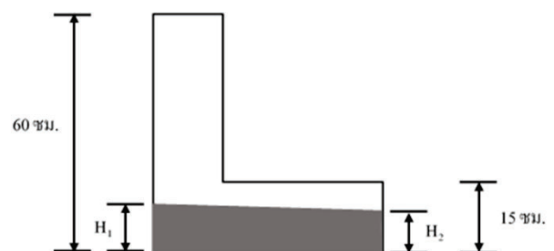
รูปที่ 5 การวัดค่าผลการทดสอบ L-box
