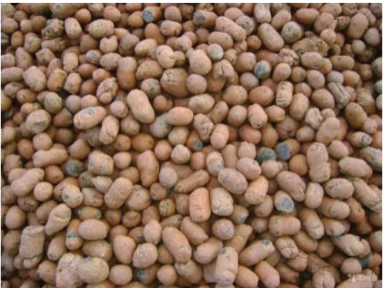
รูปที่ 1 ลักษณะทางกายภาพของเม็ดดินเหนียวขยายตัวเบา (LECA)
