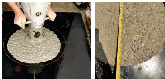
รูปที่ 2 การทดสอบค่าการไหลแผ่และระยะเวลาการไหล T_{500}
