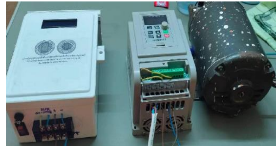
รูปที่ 11 ภาพแสดงการต่ออุปกรณ์วงจรบูทแรงดันไฟฟ้ากระแสไฟฟ้าตรงเพื่อให้แรงดันไฟฟ้าที่อินเวอร์เตอร์ขับเคลื่อนมอเตอร์
