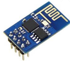
รูปที่ 2 โหนด เอ็มซียู ESP8266
