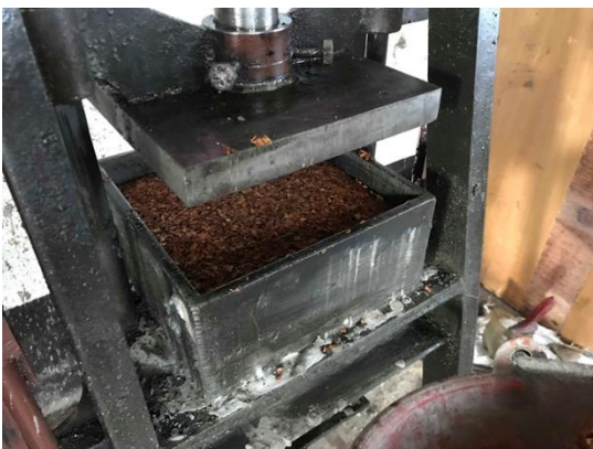
รูปที่ 5 นำฉนวนกันความร้อนออกจากเครื่องอัดไฮดรอลิก
