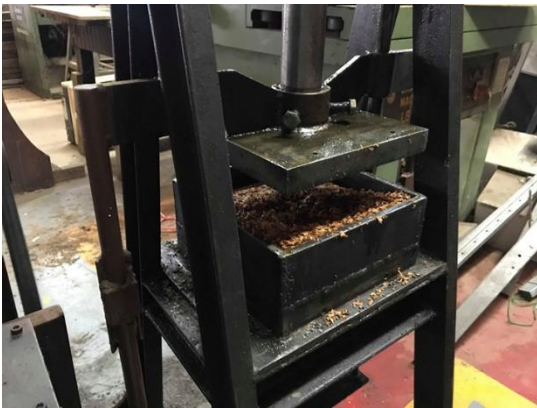
รูปที่ 4 นำอัตราส่วนผสมเข้าเครื่องอัดไฮดรอลิก
