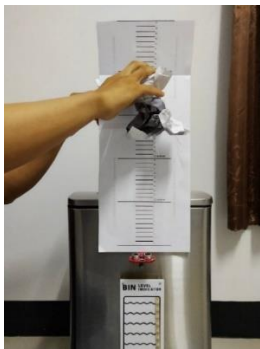
รูปที่ 12 การทดสอบการทำงานของโมดูลวัดระยะทางตัวที่ 1
