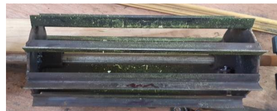
รูปที่ 1 ชุดใบมีดลอกผิวใบสับปะรด จำนวน 8 ใบ
