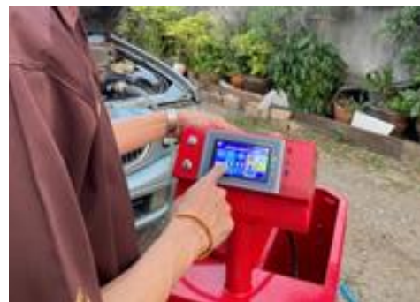
รูปที่ 11 กดปุ่มเริ่มการล้างหม้อน้ำ
