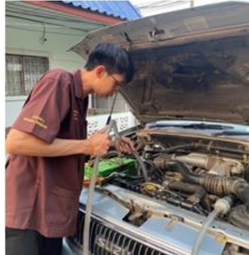
รูปที่ 10 ติดตั้งท่อทางเข้าและทางออกของระบบน้ำวน
