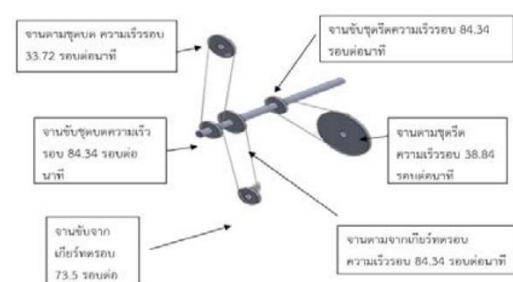
รูปที่ 2 ความเร็วรอบในระบบส่งกำลังของเครื่องบดเศษหน่อไม้
