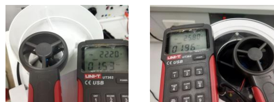
รูปที่ 10 การทดสอบวัดความเร็วลมในการระบายอากาศ
