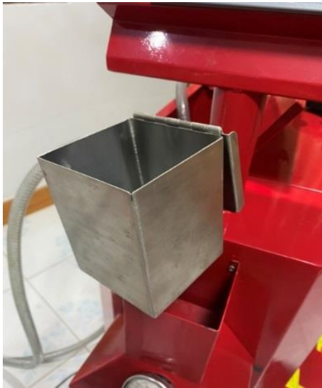
รูปที่ 6 ติดตั้งกระป๋องเติมน้ำยาล้างหม้อน้ำ
