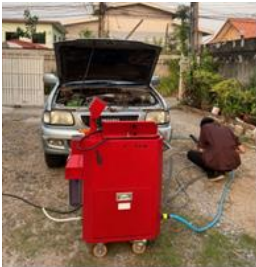
รูปที่ 9 เตรียมเครื่องล้างหม้อน้ำรถยนต์
