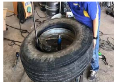
รูปที่ 9 ใช้เหล็กงัดยางมางัดขอบยางให้ขึ้นจากขอบล้อ
