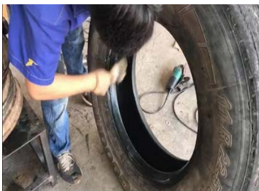
รูปที่ 11 นำครีมมาทาขอบยางเพื่อให้ไม่เกิดความฝืด
