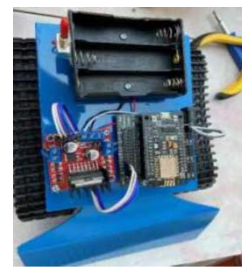
รูปที่ 4 การติดตั้งอุปกรณ์ในการออกแบบหุ่นยนต์พื้นฐานควบคุมด้วย สมาร์ทโฟน ผ่านสัญญาณบลูทูธ
