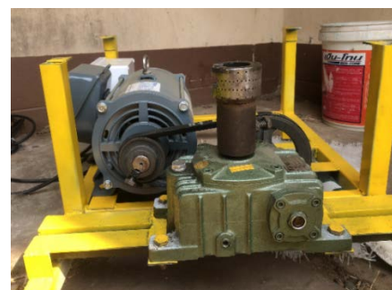
รูปที่ 6 ติดตั้งมอเตอร์ไฟฟ้าและเกียร์ทดรอบ
