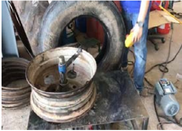
รูปที่ 10 ถอดยางออกจากกระทะล้อรถบรรทุก
