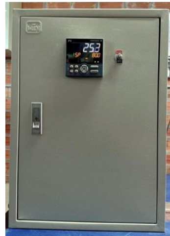
รูปที่ 3 แสดงตู้ชุดควบคุมอุณหภูมิน้ำพรมกากอ้อยแบบอัตโนมัติ
