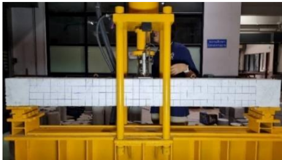
รูปที่ 4 การติดตั้งอุปกรณ์และตัวอย่างคานสำหรับการทดสอบ
