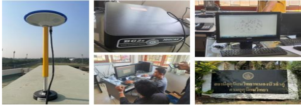
รูปที่ 4 การติดตั้งเครื่องรับสัญญาณ BG2s ที่สถานี อุตุณิยมหาวิทยาลัยราชภัฏหนองบัวลำภู
