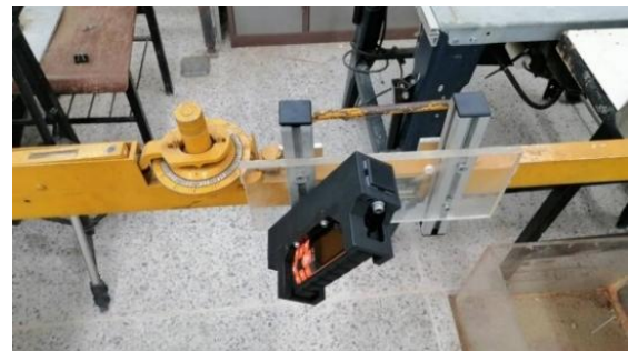
รูปที่ 3 เครื่องวัดมิติอุโมงค์ รุ่นที่ 2 เมื่อนำมาติดตั้งยึดกับเครื่องวัดขนาดทางแบบทันสมัยของการรถไฟฯ [2]
