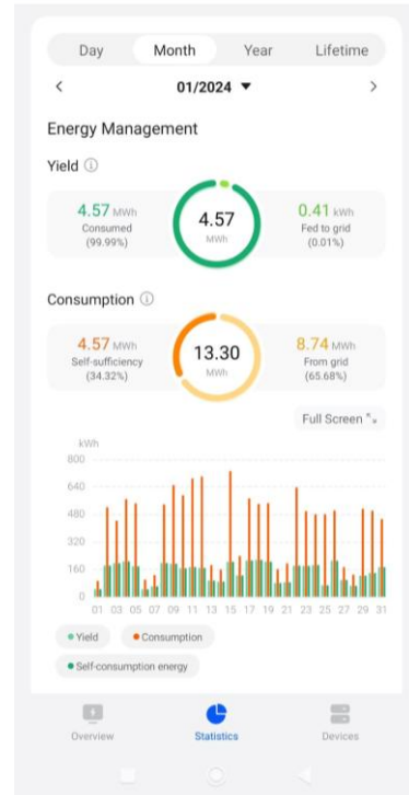
รูปที่ 5 ผลการวัดพลังงานไฟฟ้าในหนึ่งเดือนสำหรับอาคารเรียน วิทยาลัยเทคนิคหนองบัวลำภู
