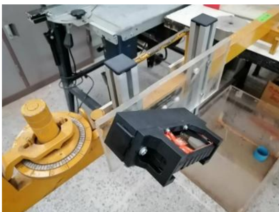
รูปที่ 9 เครื่องวัดมิติตามขวางอุโมงค์รถไฟรุ่นที่ 2 ซึ่งนำงาน องศาออกและสามารถวัดมุมได้ด้วยตนเอง [7]
