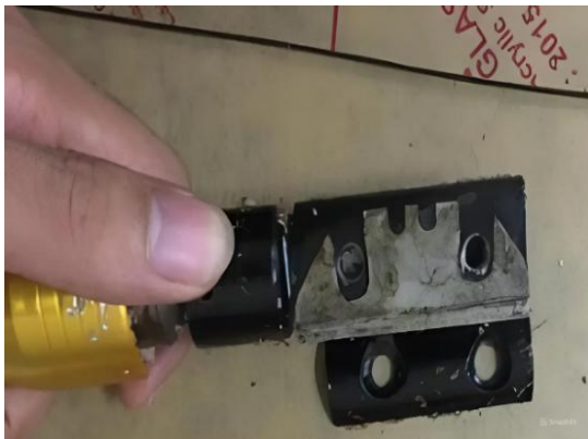
รูปที่ 4 ลักษณะการประกอบชุดใบมีด
