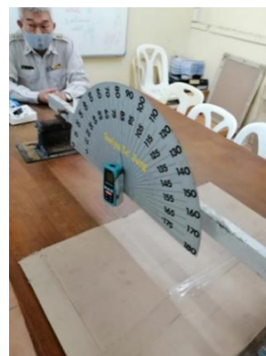
รูปที่ 7 เครื่องมือวัดมิติอุโมงค์รุ่นที่ 1 ประกอบด้วยจานองศาครึ่งวงกลม เครื่องเลเซอร์วัดระยะแบบมือถือติดตั้งบนเครื่องวัดขนาดทางที่ทันสมัยของการรถไฟฯ [1]
