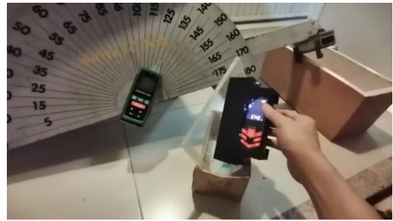
รูปที่ 2 เครื่องวัดมิติอุโมงค์ รุ่นที่ 2 โดย กิตติเดช สันติชัยอนันต์ [2] เทียบกับเครื่องมือวัดมิติอุโมงค์ รุ่นที่ 1
