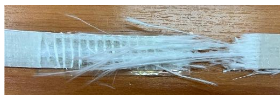
รูปที่ 2 การทดสอบแผ่นโพลิเมอร์เสริมเส้นใยแก้ว
