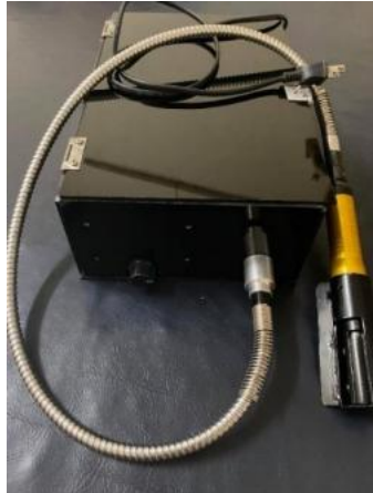
รูปที่ 7 เครื่องเกลาคิวชั้นในของผลมะพร้าวแบบพกพาที่ประกอบเสร็จแล้ว
