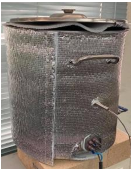
รูปที่ 7 เครื่องสกัดน้ำตาลจากมอลต์ที่มีการควบคุมอุณหภูมิ แบบป้อนกลับ
