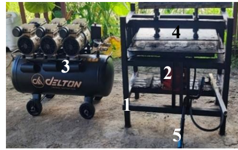
รูปที่ 5 เครื่องอัดกลับดำแบบกึ่งอัตโนมัติระบบไฮดรอลิกส์ไฟฟ้า
