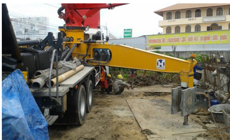
ภาพที่ 4 บรรยากาศฝึกอบรมภาคปฏิบัติ : การกางยึด-ตั้งขา และ ยึดกางบูม
