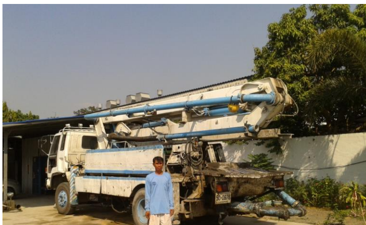
ภาพที่ 2 ผู้บังคับการบรรทุกติดตั้งปั๊มคอนกรีตแบบมีบูมของ บจก.วัฒนะพูนทรัพย์
