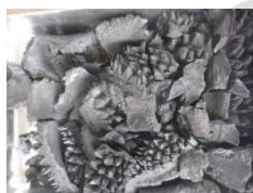
ภาพที่ 1 ลักษณะวัสดุและถ่านชีวภาพ จากเปลือกทุเรียน
