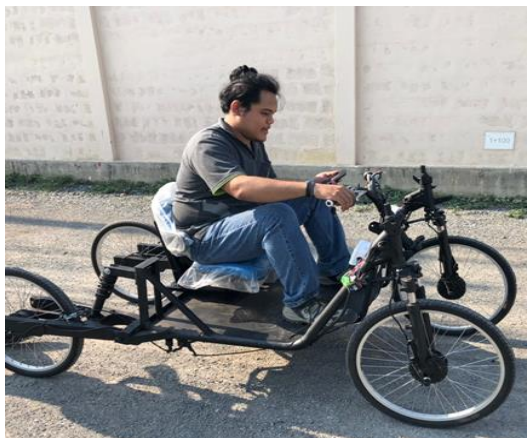
ภาพที่ 2 รถไฟฟ้าขนาดเล็กขับเคลื่อนแบบ 4 ล้ออิสระ 4 มุมมอง
