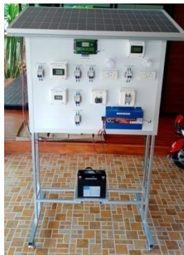
ภาพที่ 4 ระบบสาธิตผลิตกระแสไฟฟ้าพลังงานแสงอาทิตย์
