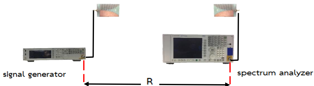
ภาพที่ 9 การทดสอบวัดอัตราขยายของสายสายอากาศวิวลติแอนติโพดอล
