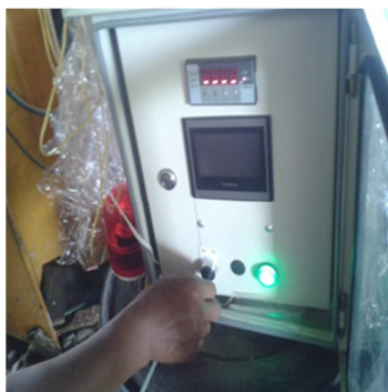
รูปที่ 3 การทดสอบระบบควบคุมการชุบโลหะอัตโนมัติ โดยใช้พีแอลซี และเอชเอ็มไอ
