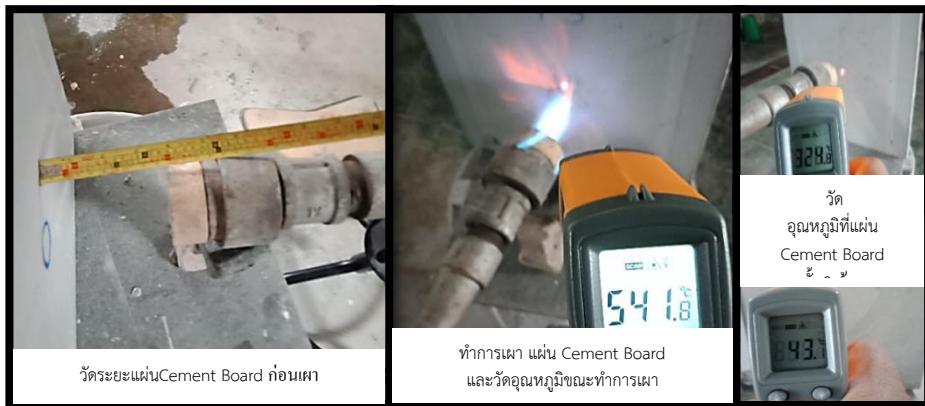
ภาพที่ 6 แสดงทดสอบการทนไฟ
