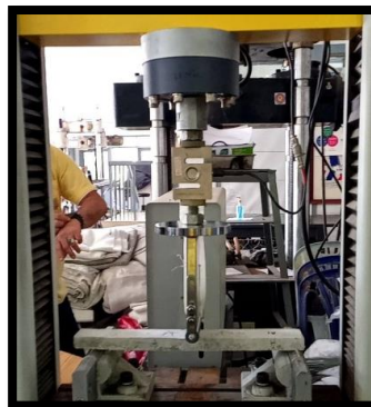
ภาพที่ 3 แสดงเครื่องทดสอบมอดูลัสยืดหยุ่น
