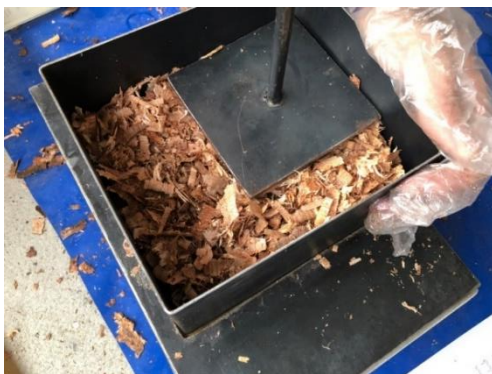
ภาพที่ 7 การบดอัดส่วนผสมเบื้องต้นให้แน่นอยู่ภายในแบบหล่อด้วยเหล็กกระทง
