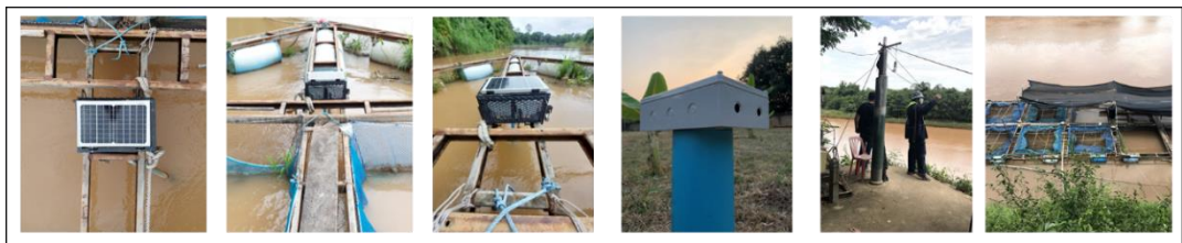
ภาพที่ 5 ติดตั้งอุปกรณ์สำหรับตรวจวัดคุณภาพน้ำในการเลี้ยงปลาในกระชัง
