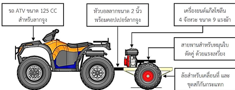
ภาพที่ 1 โครงสร้างเครื่องตัดหญ้าทางลากใบพัดแรงเหวี่ยงคู่
