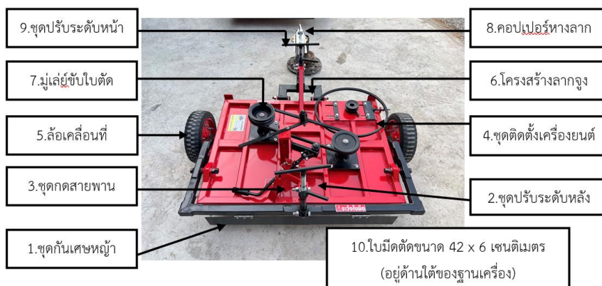
ภาพที่ 2 โครงสร้างหางลากใบตัดแรงเหวี่ยงคู่
