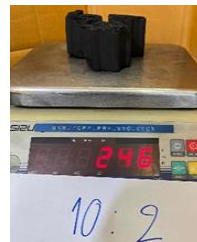
ภาพที่ 4 ลักษณะทางกายภาพของถ่านไม้โกงกางและถ่านอัดแท่งที่อัตราส่วน 5% (10 : 0.5) 10% (10 : 1) และ 20% (10 : 2)
