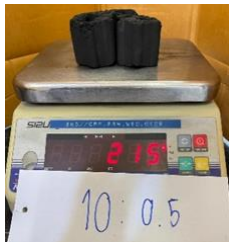
ภาพที่ 4 ลักษณะทางกายภาพของถ่านไม้โกงกางและถ่านอัดแท่งที่อัตราส่วน 5% (10 : 0.5) 10% (10 : 1) และ 20% (10 : 2)
