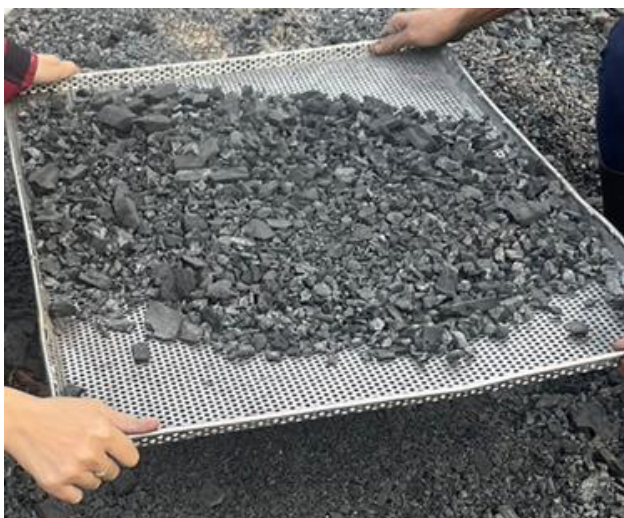
ภาพที่ 1 เศษถ่านที่ผ่านการร่อนด้วยตะแกรงขนาด 4 มิลลิเมตร
