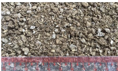
ภาพที่ 3 กากมูลโคนมแห้ง จากฟาร์มโคนมในอำเภอมวกเหล็ก จังหวัดสระบุรี ขนาดผ่านตะแกรงเบอร์ 4
