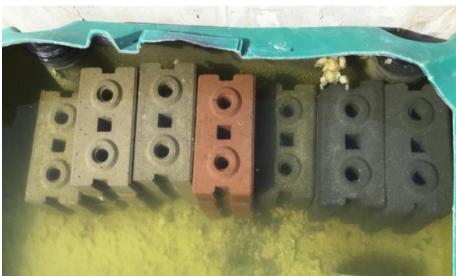
ภาพที่ 9 การแช่อิฐบล็อกประสานในน้ำสะอาดเพื่อทดสอบการดูดซึมน้ำ
