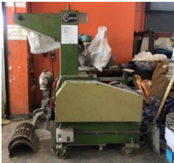
ภาพที่ 4 เครื่องบดย่อยกากมูลโคพร้อมตะแกรงคัดขนาด (ที่มา: ประชุม คำพูน, 2566)
