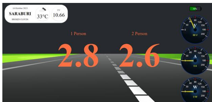
ภาพที่ 10 แสดงเว็บแอปพลิเคชันแสดงค่าระยะทางที่วิ่งได้ แรงดันไฟฟ้า กระแสไฟฟ้า และกำลังไฟฟ้า
