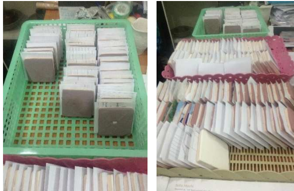
ภาพที่ 2 ชั้นทดสอบที่ทำการจุ่มน้ำเคลือบแล้วรอการเผาเคลือบ
