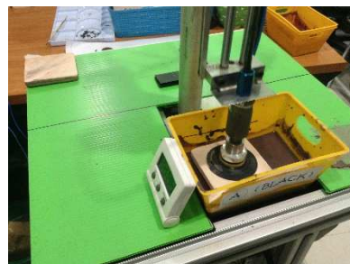
ภาพที่ 4 เครื่องจุ่มดูดชั้นทดสอบไปจุ่มเคลือบ
