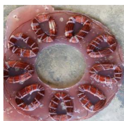
ภาพที่ 3 ชุดสเตเตอร์ที่สร้างจริง
