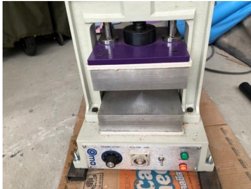
ภาพที่ 3 เครื่องขึ้นรูปแผ่นขึ้นไม้อัดด้วยความร้อนชนิดอัตราแบบใช้มือหมุน
