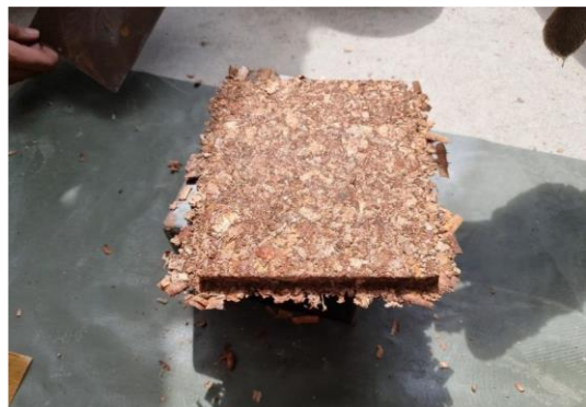
ภาพที่ 8 แผ่นขึ้นไม้อัดจากเศษกิ่งไม้ต้นมะยงชิดที่ผ่านการขึ้นรูปเรียบร้อยแล้ว
