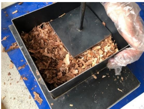
ภาพที่ 7 การบดอัดส่วนผสมเบื้องต้นให้แน่นอยู่ภายในแบบหล่อด้วยเหล็กกระทง
