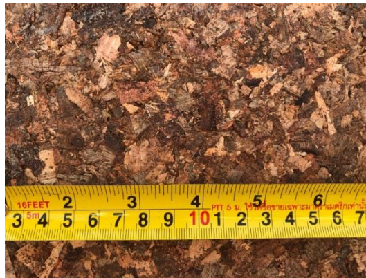
ภาพที่ 11 ผิวหน้าของแผ่นขึ้นไม้อัดจากเศษกิ่งไม้ต้นมะยงชิด
