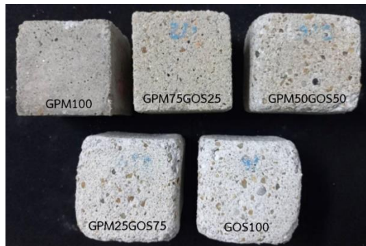
ภาพที่ 8 ลักษณะทางกายภาพของตัวอย่างจีโอโพลิเมอร์มอร์ตาร์จากหินพัมมิสผสมเปลือกหอยนางรมเผา บดละเอียดที่แช่ในสารละลายกรดซัลฟิวริกความเข้มข้นร้อยละ 3 ที่อายุ 180 วัน
