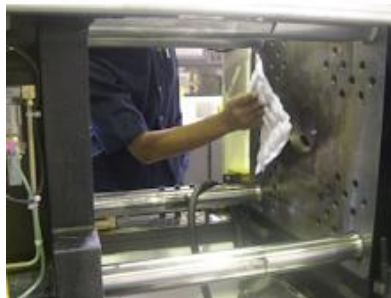
ภาพที่ 9 เครื่องขึ้นรูปขึ้นททดสอบโดยวิธีการฉีดด้วยเครื่องฉีด
