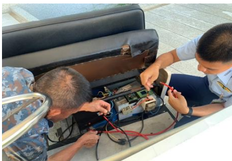
ภาพที่ 7 การติดตั้งตัวจับสัญญาณแบตเตอรี่เข้ากับรถไฟฟ้าพลังงานแสงอาทิตย์
