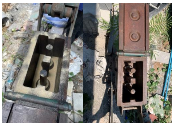
ภาพที่ 5 เครื่องอัดอิฐบล็อกประสานแบบมือโยกพร้อมติดตั้งแบบหล่อขนาด 22.5x11.5x6 ซม. (ที่มา: ประชุม คำพูน, 2566)
