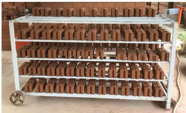
ภาพที่ 7 การบ่มอิฐบล็อกประสานในสภาพอากาศปกติ
