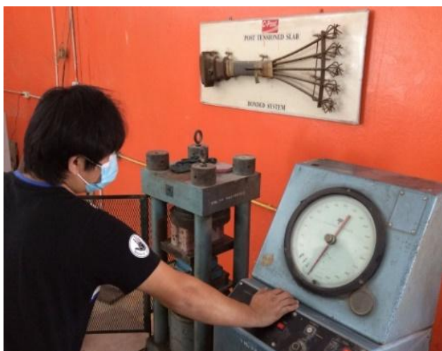
ภาพที่ 8 การทดสอบความต้านแรงอัดของอิฐบล็อกประสาน
