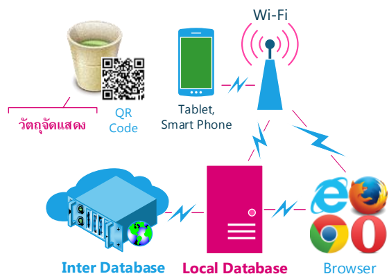
ภาพที่ 6 โครงสร้างระบบนำชมด้วยอาร์เอฟไอดี สำหรับการเยี่ยมชมภายใน
