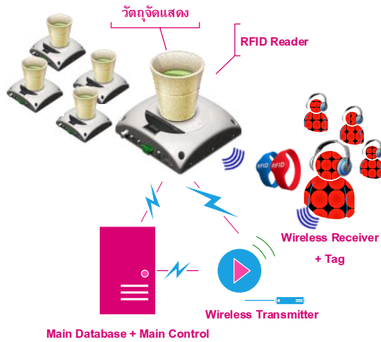
ภาพที่ 1 ภาพรวมของระบบนำชมด้วยอาร์เอฟไอดี
